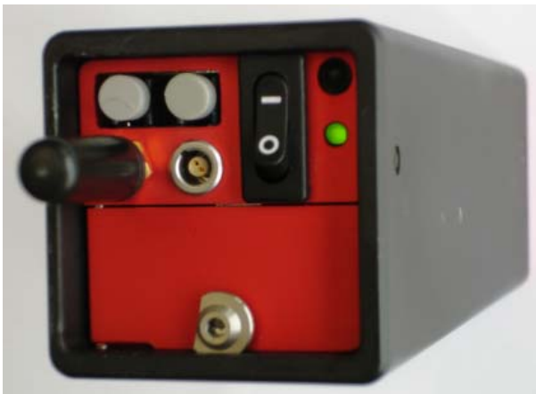
Bild 5.3: LWL-Buchsen an GEPARD mit Plastikstopfen
