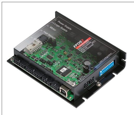
Obr. 1. Inovovaná jednotka pro řízení polohy Epos2 je díky interpolovanému řízení polohy IPM schopna řídit synchronizovaný pohyb po trajektorii zadané definičními body; Epos2 50/5 s rozhraním USB se používá s kartáčovými i bezkartáčovými stejnosměrnými motory s Hallovými sondami a inkrementálním snímačem v rozsahu 5 až 250 W
