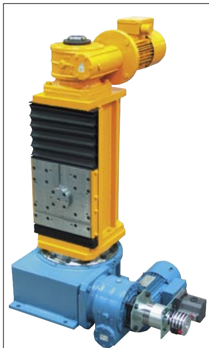
Dva jednoduché manipulátory tvoří Sopamat pro vykonávání složitějšího pohybu. Na upínací desku se připevní rameno pro manipulaci výrobkem. Spouštění a zastavování motorů se řídí technologickým procesem a koncovými spínači.
