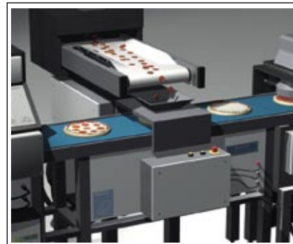
Pohyb dopravního pásu s ozubením je synchronizován s výrobními operacemi. Ozubení stabilizuje pás i bočně.
