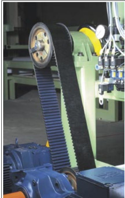
Převod synchronizačním řemenem není během provozu potřeba periodicky dopínat.
