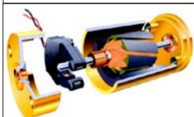
S vinutím konvenčního motoru DC se otáčí jádro z ocelových plechů
