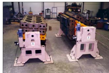
Manipulační kolébka. Nosník s upnutými výrobky se natáčí mezi dvěma nebo třemi polohami. Jedna z nich je určena pro upnutí nového výrobku. V ostatních polohách probíhá automatický technologický proces.
