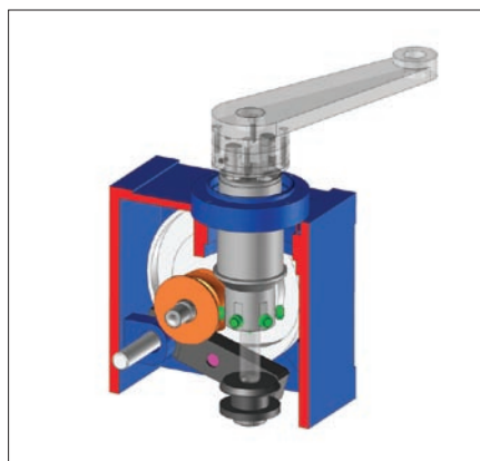
Obr. 1. Otočný manipulátor s mimoběžnými osami série M a princip funkce; zdvih se realizuje radiální vačkou, otočení globoidní vačkou; Obě vačky jsou na společné vstupní hřídeli
