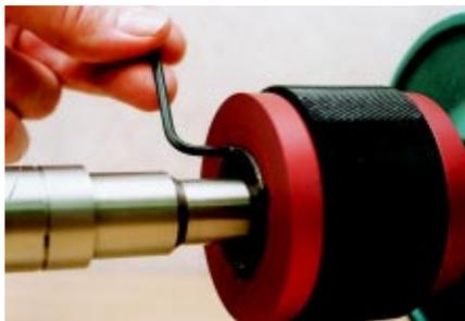
Schrauben abwechselnd gleichmäßig anziehen
