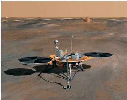
Seďm motorů maxon RE25 natáčí solární články. Phoenix Mars Scout Lander je první sonda v rámci programu Mars Scout a letos bude vyslána k planetě Mars. Přistane na severní polokouli, poblíž polární čepičky, kde sonda Mars Odyssey 2001 objevila velké zásoby vodního ledu.
