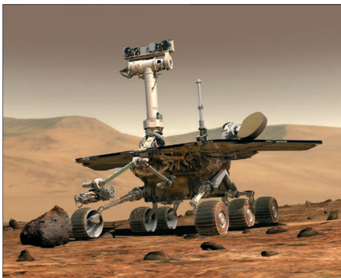
Obr. 1. Šestikolový robot zkoumá Mars. Po úspěšné misi sondy 2001 Mars Odyssey vyslala NASA v roce 2003 na planetu Mars dvojici pojízdných geologických laboratoří. Hlavním úkolem dvojice robotů – roverů je pátrání po stopách vodního prostředí a přírodního života na Marsu. Každý rover má při rozměrech 1,5 x 2,3 x 1,6 m (v x š x d) hmotnost 174 kg a obsahuje 31 motorů maxon.
