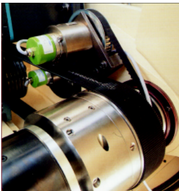
Převod s využitím polyuretanového klínového řemenů Polyflex JB
