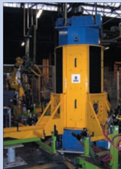
obr. 2 Na vodorovném disku velkého otočného stolu jsou čtyři vačkové lineární jednotky pro vertikální pohyb. Nosníky lineárních jednotek přebírají karosérie z dopravníku a během pootáčení do technologických pracovišť je vertikálně nastavují. Robotizovaná pracoviště jsou rozmístěna po obvodu stolu.
