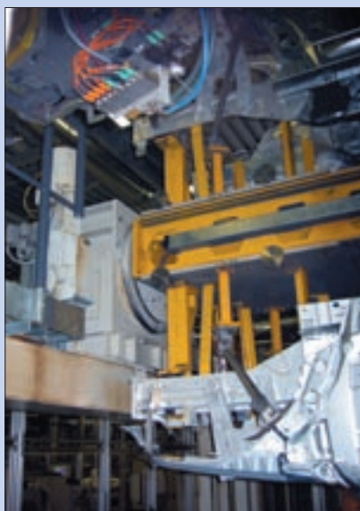
obr. 1 Na disk otočného stolu s vodorovnou osou otáčení jsou připevněny upínače dílů karosérie pro dvě technologická místa.
