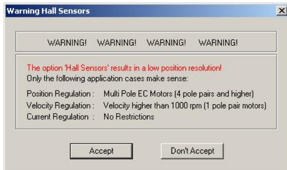
Obrázek 19: Doporučení pro použití Hallových snímačů jako snímače polohy.
