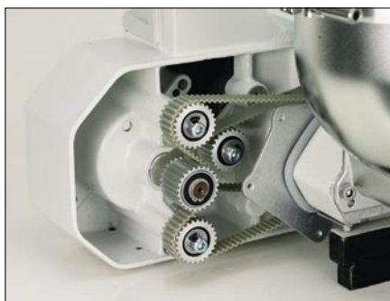
Obr. 4. Převod s ozubenými řemenicemi a řemeny značky Wekbug
