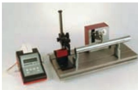
Messen der Rauheit radial am inneren und äusseren Umfang von zylindrischen Teilen mit dem Zusatzgerät DIAVITE Tube-master
