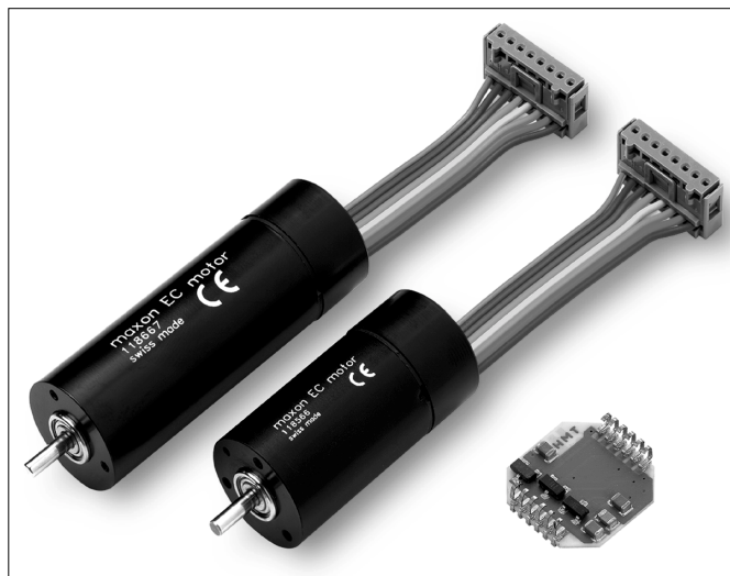
Obr. 2. Stejnospměrný motor Maxon EC22 ( \varnothing 22 mm, 50 W) s vestavěnou elektronikou (vlevo nahoře), tentýž motor bez elektroniky (uprostřed) a hybridní obvod integrované elektroniky zajišťující komutaci (vpravo dole)
