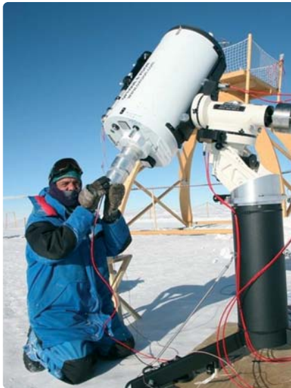
Výzkumná stanice v Antarktidě, maxon motor v teleskopu při -75\text{ °C} .
