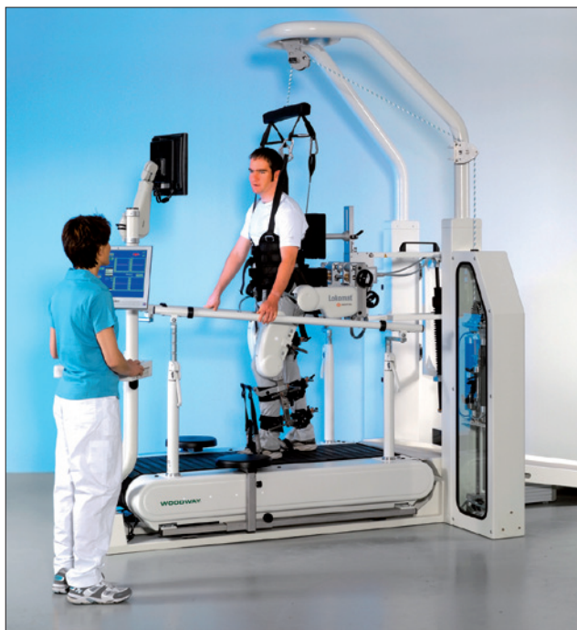
Obr. 4. Terapeutický robot Lokomat firmy Hocoma pro podporu motoriky
