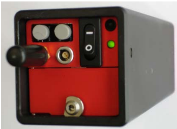
Bild 5.3: LWL-Buchsen an GEPARD mit Plastikstopfen
