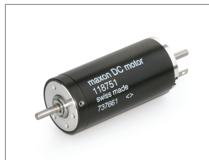
Obr. 4. Komutátorový motor RE 25 s grafitovými kartáči má výkon 20 W, otáčky až 15 000 min -1 , vnější průměr 25 mm a délku 55 mm; grafitové kartáče jsou určeny pro provoz s častými rozběhy a přetěžováním
