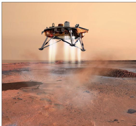
Obr. 3. Zobrazení sondy s raketovými motory v činnosti před dosednutím
