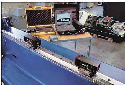
Obrázek 1: Fotografie konkrétní měřicí úlohy. Laserový přijímač a vysílač jsou umístěny na vedení. Přijímačem se pohybuje a ve zvolených bodech se měří poloha dopadajícího paprsku na detektor. Data jsou pak vyhodnocena softwarem na PC.
