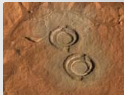
Takto vypadá práce brusky z robotů MER na kamenech Marsu.
