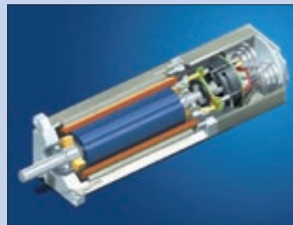
Obr. 4 Průmyslové provedení stejnosměrného motoru s elektronickou komutací EC45. Motor se pro automatické a ruční nářadí se zatížením 0.5 Nm používá bez převodovky.
