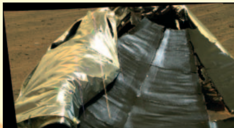
Trosky tepelného štítu, který chránil robota Opportunity při přistávacím manévru na Marsu.
